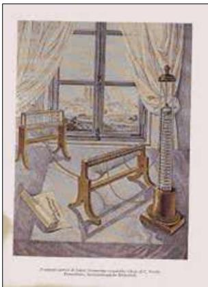
Il telegrafo di Sommering utilizza invece un sistema elettro-galvanico, dopo l'invenzione della pila di Volta
