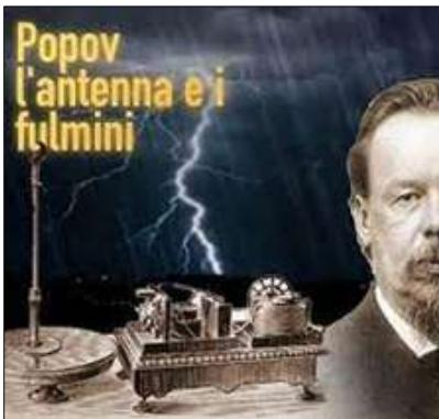
Il ricevitore di temporali di Popov si basa sulla captazione delle onde elettromagnetiche generate dai fulmini fino a 20 km di distanza.
